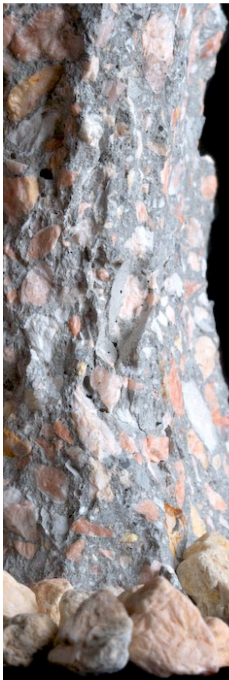
Przykłady przekrojów betonów ciężkich wykonanych na bazie kruszyw specjalnych
